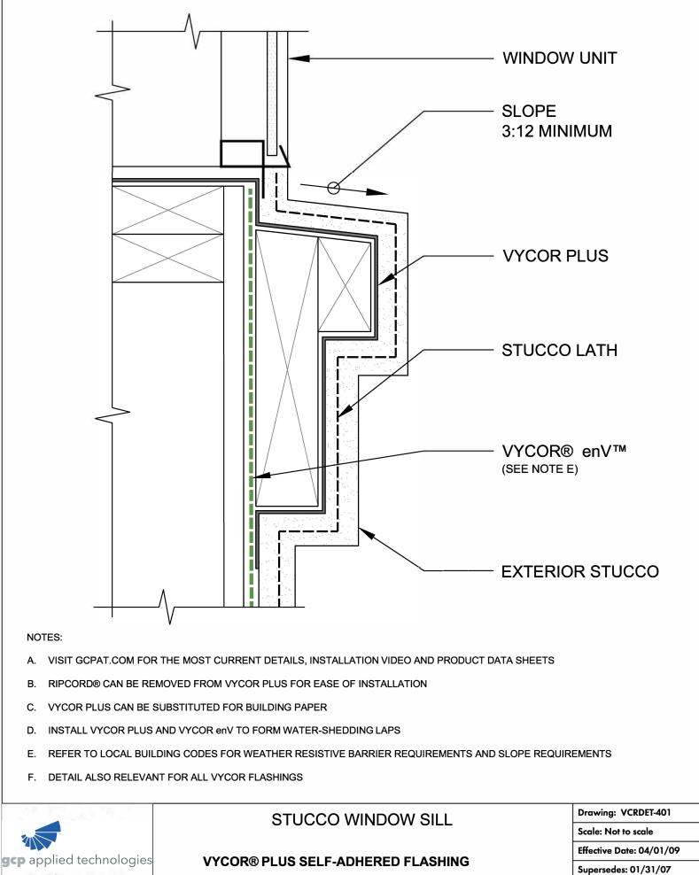
**VYCOR® PLUS SELF-ADHERED FLASHING**
